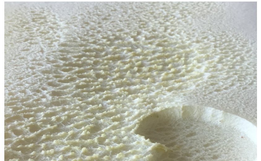
〈그림 5〉 단열재 소재인 아이소골드에 히트건으로 녹여 패턴을 만들었다. 히트건의 움직이는 속도와 재료와의 거리를 통제하며 녹으면서 어떠한 패턴이 생기는지 관찰하였다. 사진_황동욱
