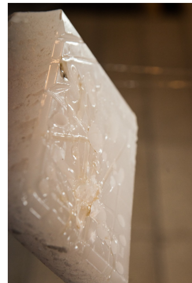
〈그림 8〉 마가린은 잘 녹았지만 굳는데 비교적 오랜 시간이 걸렸고, 굳은 상태도 단단하지 않아 파라핀왁스로 같은 작업을 진행했다.
