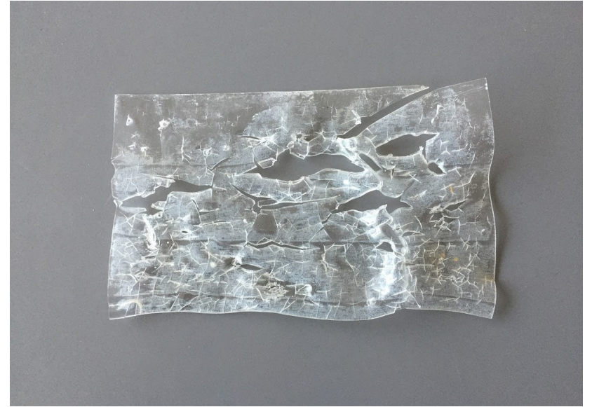
〈그림 4〉 아크릴에 투명테이프를 붙이고 잘게 조각낸 후, 히트건(heat gun)을 이용하여 재결합시켜 상태변화를 통한 불규칙적인 패턴을 만들었다. 사진_황동욱
